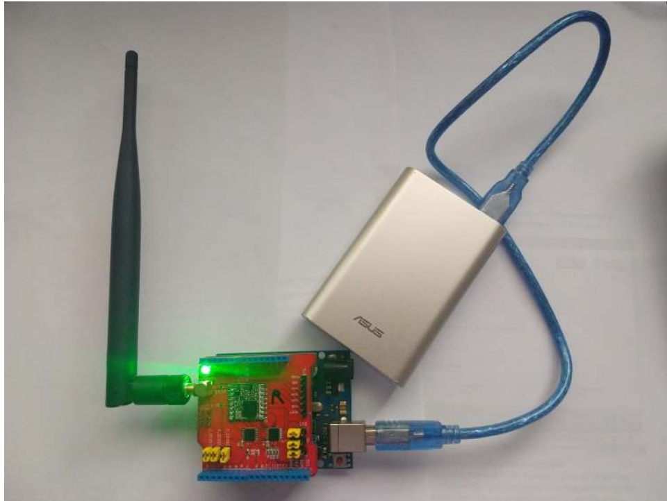
Figura 10 – Protótipo do dispositivo emissor conectado ao powerbank
