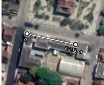
Figura 16 – Distância entre receptor e emissor no teste de 62 metros
